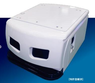
内蔵カメラで目印となる「サインポスト」を認識し、独自の制御システムで自律移動を可能とします。
